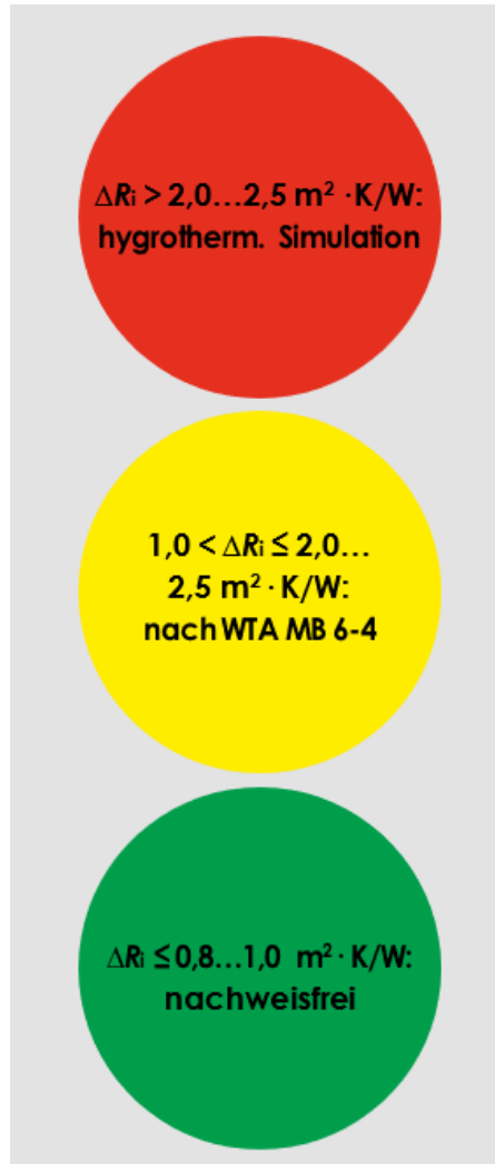
Abbildung: Innendämmungsampel – Grenzen der verschiedenen Dämmniveaus und Risiko für die Bestandskonstruktion aus Praxishandbuch Innendämmung herausgegeben vom Fachverband Innendämmung e.V. (Quelle Jürgen Gänßmantel, Kaufbeuren)
